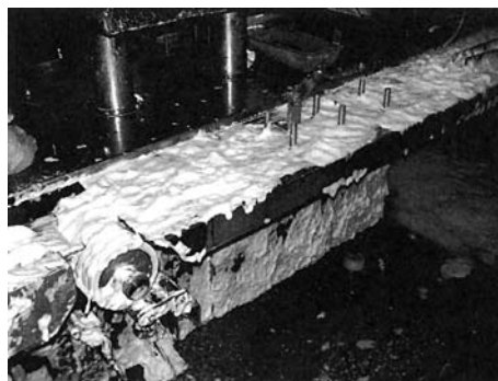
写真5 泡洗浄の様子
